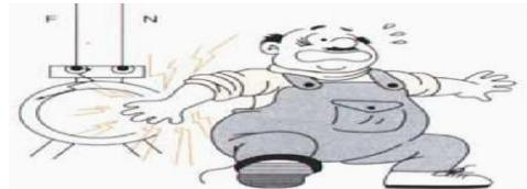
Se entenderá que queda sometido a una tensión **por contacto indirecto**, cuando toca con alguna parte de su cuerpo una parte metálica de un equipo eléctrico, que en condiciones normales está desenergizado, pero que en condiciones de falla se energiza.
